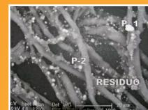
Análisis del residuo del filtro por EDS (Energy Dispersive X-Ray Spectrometer).
