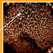
Aspecto de los filtros (0,8 micras) de ensayo estabilidad a la oxidación ASTM D-2274 modificada (PEC-1093-C. Oxidación severa: 16 horas, 95°C, borboteo de oxígeno 3 l/h, adición de Cu).
